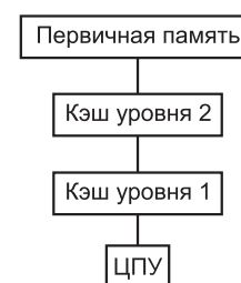
Рис. 1.1. Процессор, кэш и память в современной вычислительной машине
