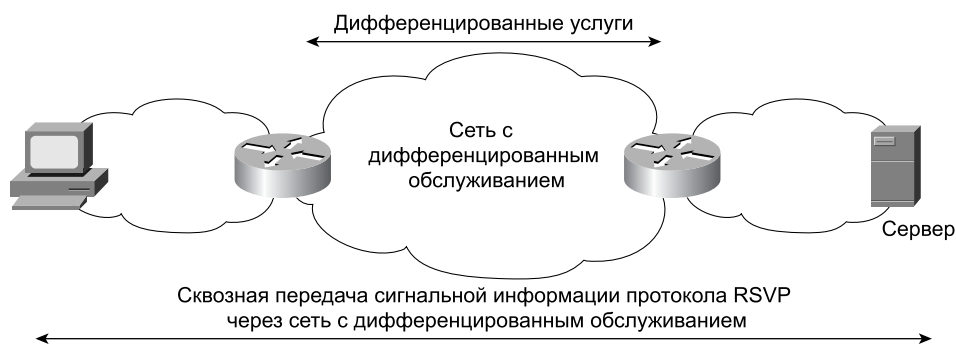
Рис. 2.5. Передача сигнальной информации протокола RSVP через сеть с дифференцированным обслуживанием
