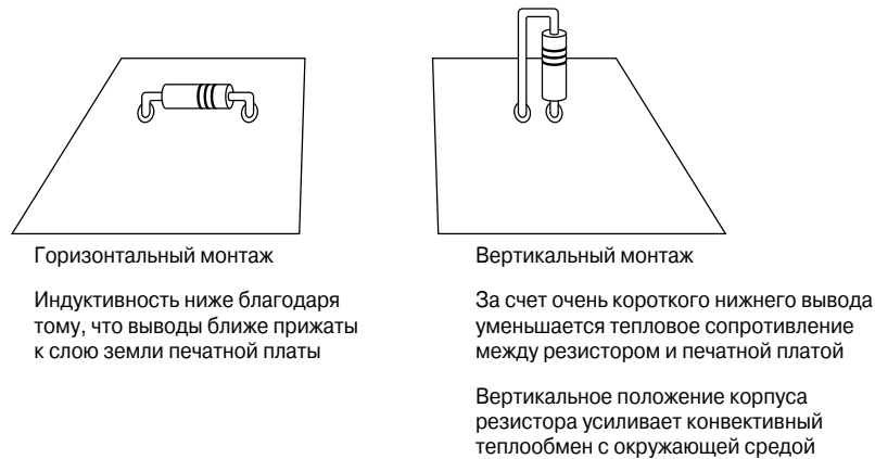
Рис. 6.13. Два варианта монтажа резисторов с аксиальными выводами
