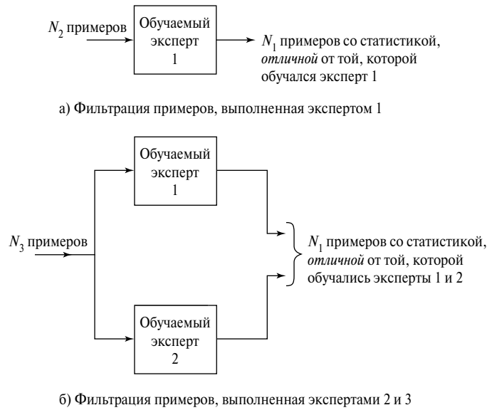
Рис. 7.2. Графически представленный процесс усиления за счет фильтрации
