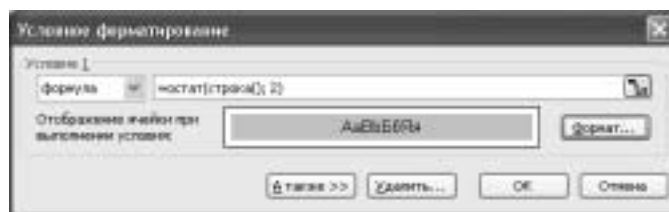
Рис. 11.3. Формула ОСТАТ() применяет затенение ячейки к каждой второй строке (к первой, третьей, пятой и т.д.)
