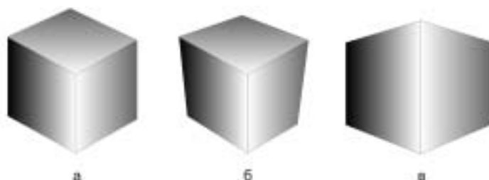
Рис. 2.21. Использование проекций различного вида для изображения трехмерных фигур на плоскости с перспективой
