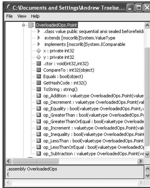
Рис. 9.1. В терминах CIL перегруженные операции отображаются в скрытые методы
