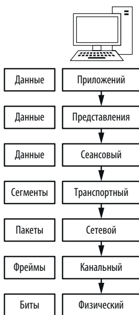
Рис. 1.1. Иерархическое представление семи уровней модели OSI
