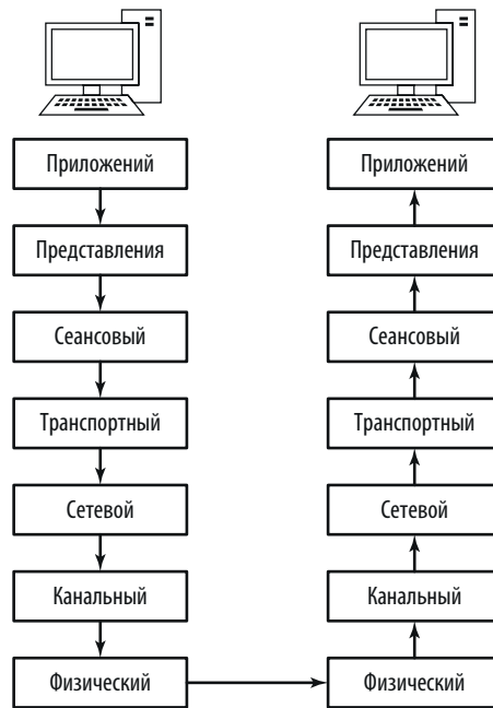
Рис. 1.2. Протоколы, действующие на одном и том же уровне как в передающей, так и в принимающей системе
