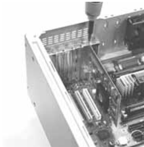
Рис. 20.27. Закрепление адаптера винтом
