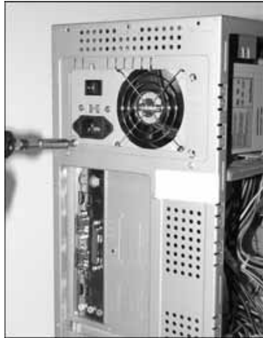
Рис. 20.19. Закрутите винты, удерживающие блок питания
