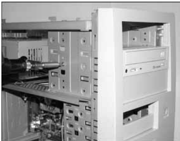
Рис. 20.23. Закрепите накопитель в корпусе, закрутив четыре винта
