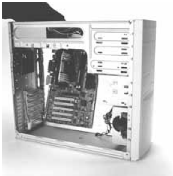
Рис. 20.16. Установка системной платы в корпус. Корпус предоставлен компанией PC Power & Cooling, Inc. Системная плата предоставлена компанией Intel Corporation
