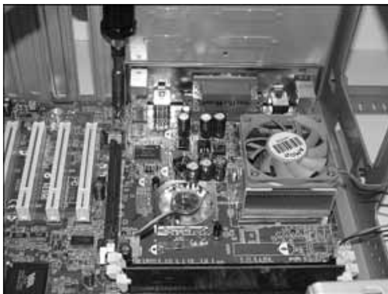
Рис. 20.17. Привинтите системную плату к корпусу
