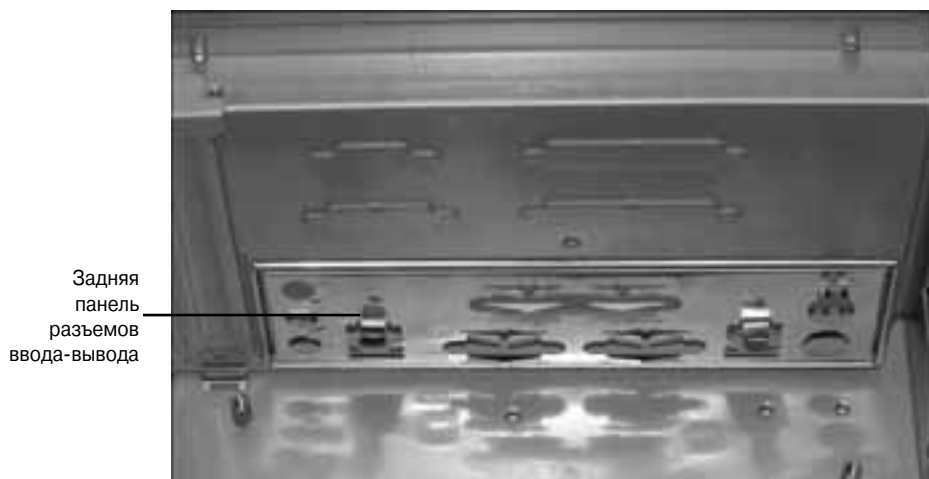
Рис. 20.15. Задняя панель разъемов ввода-вывода, установленная в корпусе
