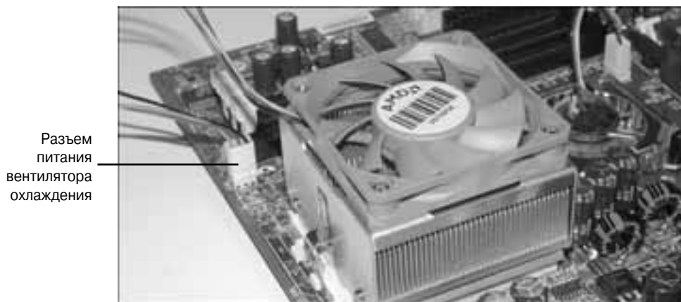
Рис. 20.7. Подключение силового разъема вентилятора к системной плате
