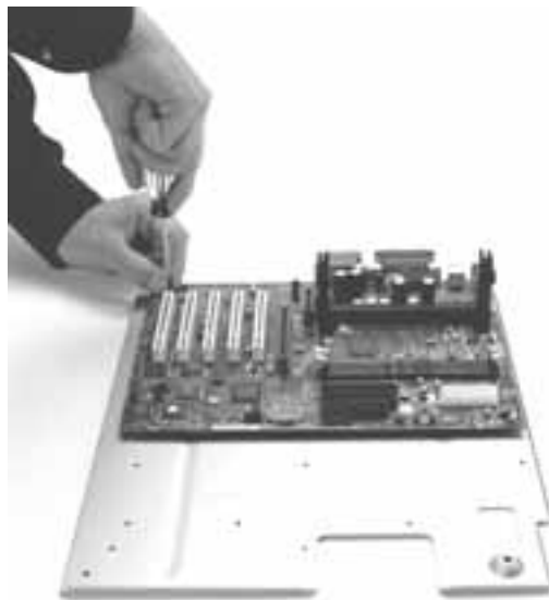
Рис. 20.14. Прикручивания системной платы к поддону. Системная плата предоставлена компанией Intel Corporation
