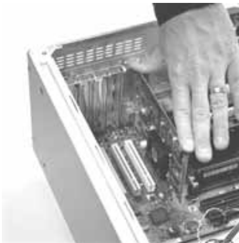
Рис. 20.26. Установка видеоадаптера в разъем системной платы
