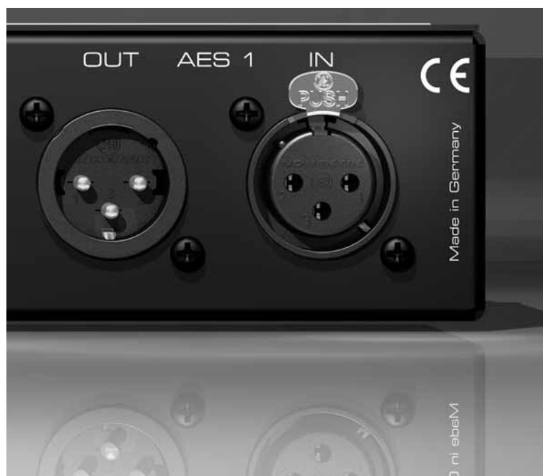
Рис. 3.6. Панельные разъемы XLR — вилка (слева) и розетка (справа) — на панели преобразователя цифровых форматов RME ADI-4 DD (публикуется с любезного разрешения компании RME, www.rme-audio.com )
