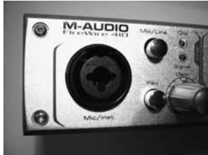
Рис. 3.4. К гнезду Neutrik “combo” ( www.neutrik.com ) подходят четвертьдюймовые TRS-вилки (штекеры) и вилки XLR. Гнезда этого типа широко используются в аппаратуре для совмещения микрофонного и линейного входов в одном разъеме, обеспечивая экономию места на панели аппаратуры (как это сделано в устройстве M-Audio 410, показанном на фотографии)
