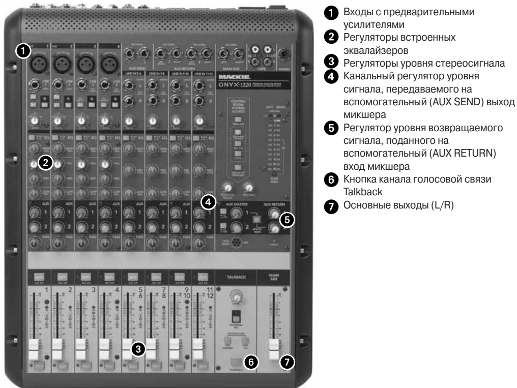
Рис. 3.10, а. По дизайну Mackie Onyx 1220 подражает аналоговым микшерам серии Mackie 1202, пользовавшимся большим успехом. Такой дизайн типичен для многих портативных микшеров. Конечно, первое, что обращает на себя внимание, — обилие разъемов, кнопок и регуляторов. Это вовсе не значит, что в процессе работы приходится пользоваться всеми этими возможностями. Достоинство традиционных аппаратных микшеров заключается в том, что они обеспечивают практически неограниченные возможности манипулирования аудиосигналами, когда это требуется, и все входы/выходы и органы управления находятся на виду, под рукой, что очень удобно (публикуется с любезного разрешения компании Loud Technologies, Inc.)
