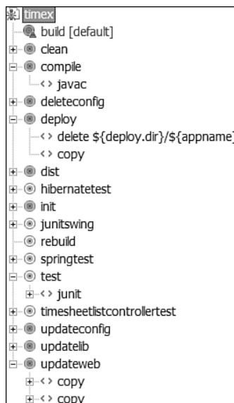
Рис. 4.3. Иерархическое представление нашего файла Ant build.xml
