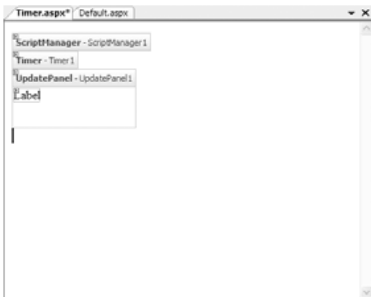
Рис. 5.12. Использование элемента управления Timer в окне конструктора
