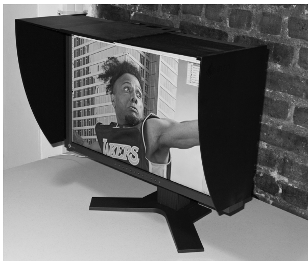
Рис. 7.2. Кожух для монитора исключает засветку от общего освещения, мешающую нормальному восприятию изображения на экране монитора
