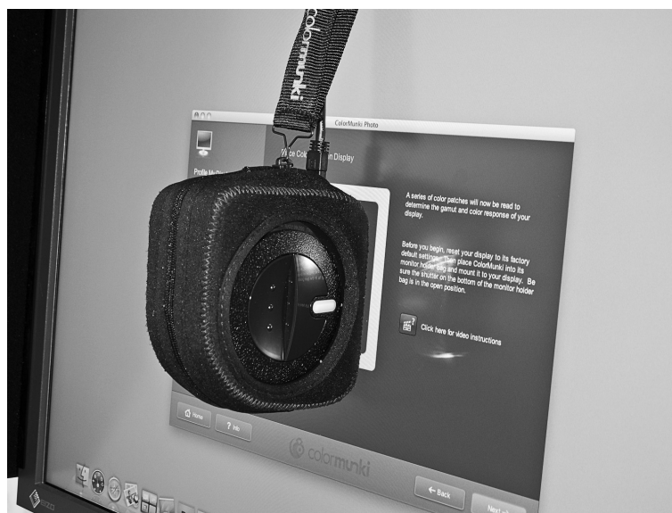
Рис. 7.7. Регулярная калибровка монитора гарантирует максимальную точность отображения просматриваемых изображений
