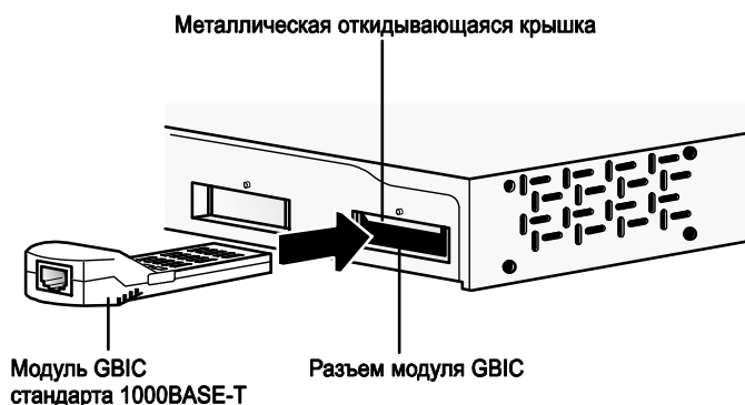
Рис. 3.5. Модуль GBIC стандарта 1000BASE-T с разъемом RJ-45
