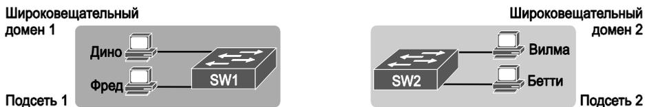
Рис. 9.1. Создание двух широковещательных доменов с двумя физическими коммутаторами и без сетей VLAN
