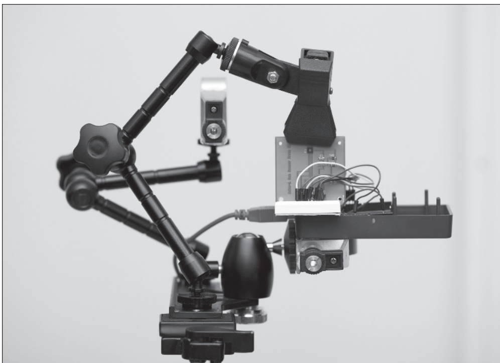
Рис. 1. Финляндия планировала запустить свой первый спутник в 2014 году. В этом же году мы сконструировали прототип анализатора солнечного излучения на базе Arduino
