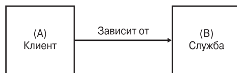
Рис. 2.1. В любом отношении зависимости зависящая сущность обозначается как клиент, а сущность, от которой она зависит, — как служба
