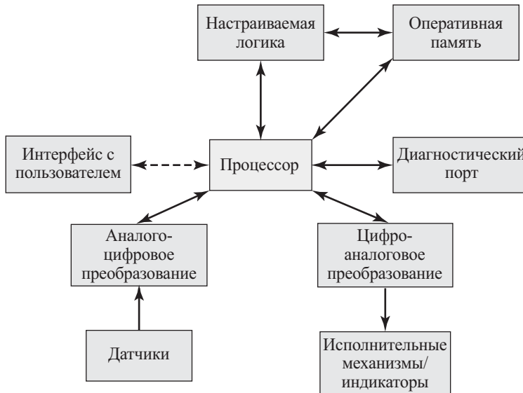
Рис. 13.1. Возможная организация встроенной системы
