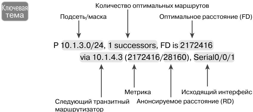
Рис. 10.4. Поля в выводе команды show ip eigrp topology
